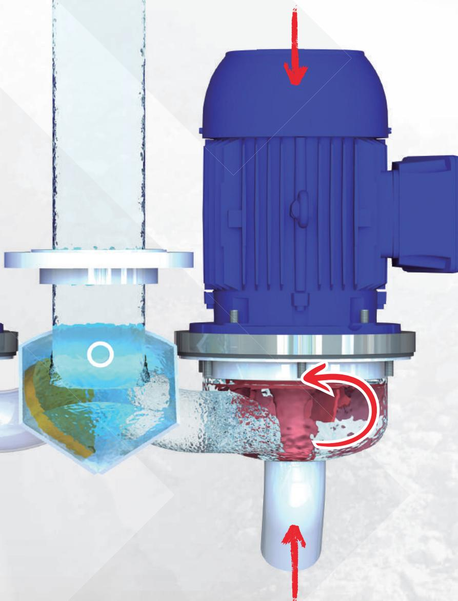
A caixa de válvula, em portinhola, atua como uma válvula de retenção com 3 posições de válvula: direita, esquerda e central; impedindo que o fluxo circule de volta, através da bomba que não está em operação.
