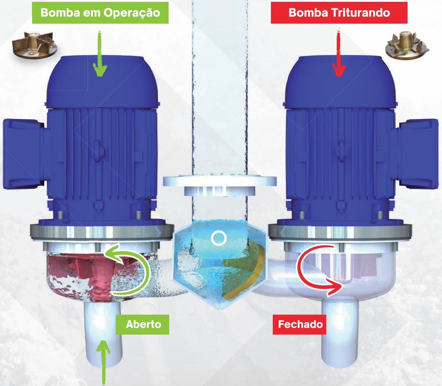
O sistema de reversão/trituração identifica automaticamente a necessidade de desbloqueio para trituração de fibras dentro da voluta. Enquanto esse processo ocorre, a bomba reserva entra automaticamente em operação para evitar extravasamento.
